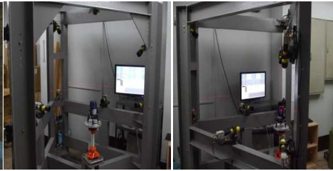
写真上:CCDカメラによる実測検査システムとデジタルコリメーターシステム
