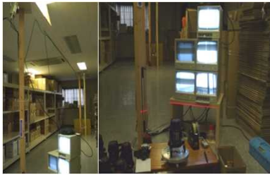
写真上:CCDカメラによる実測検査システムとデジタルコリメーターシステム
